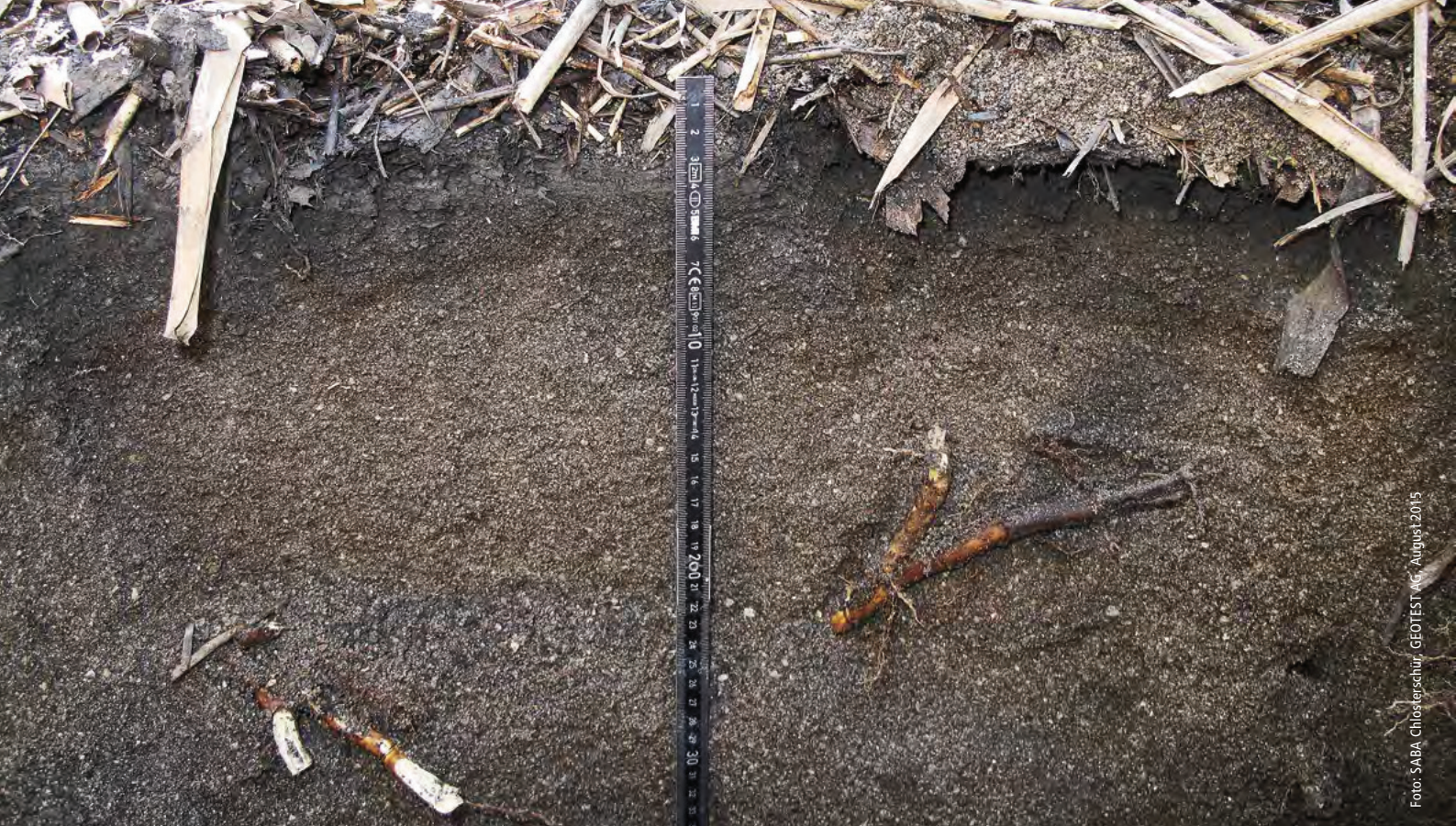
▲ Abbildung 5: Die Aufnahme zeigt den Schichtaufbau der Sandfilter-SABA: Auflage aus Schilfstreu an der Oberfläche, unmittelbar darunter ist die ca. 1 bis 2 cm starke, schwarze Sedimentschicht zu erkennen, darunter die dunkle Invasionszone mit wellig verlaufender Untergrenze bei ca. 10 cm Tiefe. Darunter befindet sich mehr oder weniger sauberer Sand. Die Partikel aus dem Strassenabwasser sind in Sedimentaflage und Invasionszone angereichert.
