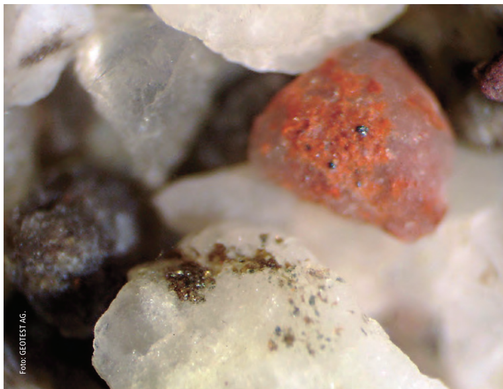
▼ Abbildung 4: Bei dieser Sandprobe aus der SABA Ristet sind schwarze Schmutzpartikel (Pneu- oder Strassenabrieb) auf Sandkörnern zu sehen. Vergrößerung ca. 100x, Auflicht.
