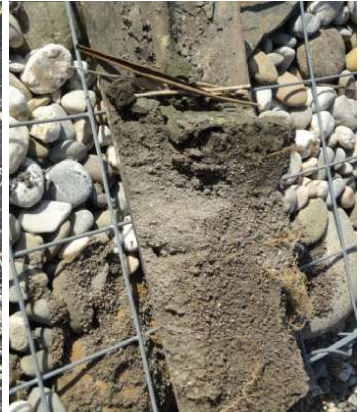
Filterkuchen auf dem Sand, Wasser durchsickert Sand gleichmässig
