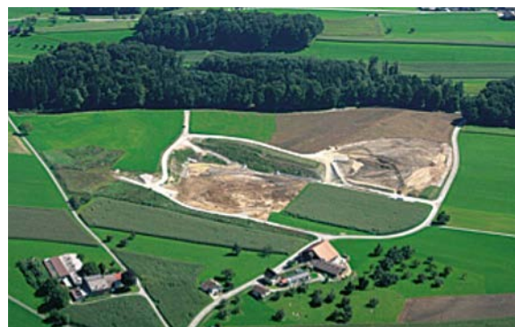
Foto 11: Situation 2 Jahre später. Der Deponiebetrieb hat sich verlagert. Abgeschlossene Kompartimente werden bereits wieder landwirtschaftlich genutzt (Foto ilu)
