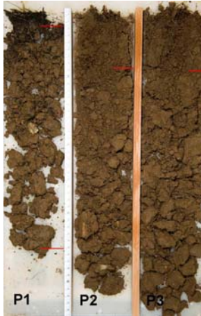
schwärzliche Ablagerungen von Pneu- und Fahrbahnabrieb
