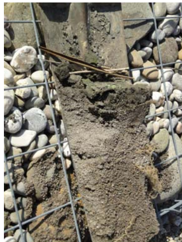
Filterkuchen auf dem Sand, Wasser durchsickert Sand gleichmässig
